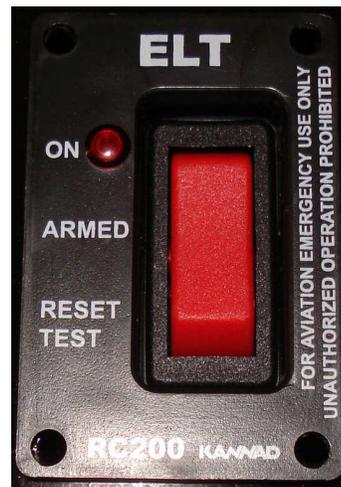
Lorsque l'avion est en service, la télécommande est en position neutre « Armed » prête à l'emploi.
