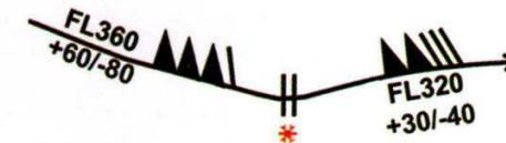
Un axe de jet est indiqué si le vent est supérieur à 80 Kt avec indications sur le vent maximal (triangle = 50 Kt, barbule = 10 Kt) et son niveau. Exemple :
